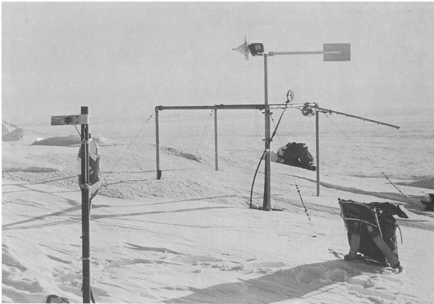
16. mynd. Endurvarpsstöð á Hlíðarfjalli fyrir sendistöðvar hallamælanna í Kröflu- öskjunni. Ljós. S.H. Sindrason
