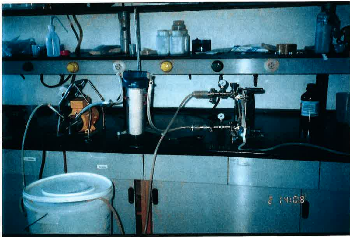
5. mynd. Stóru aurburðarsýnin voru síuð með svokallaðri “tangental filtration”. Búnaðurinn var frá Sartorius®. Síuhaldarinn var svokallaður “Sarticon Slice” síuhaldari úr ryðfrú stáli. Forsía, Micro-Klean®III glass cellulose var komið fyrir í rásinni áður en vatnið fór í “Sarticon Slice” síuhaldarann til þess að koma í veg fyrir að korn stærri en 25 \mu\text{m} kæmust í Hydrosart® síuhylkið.
