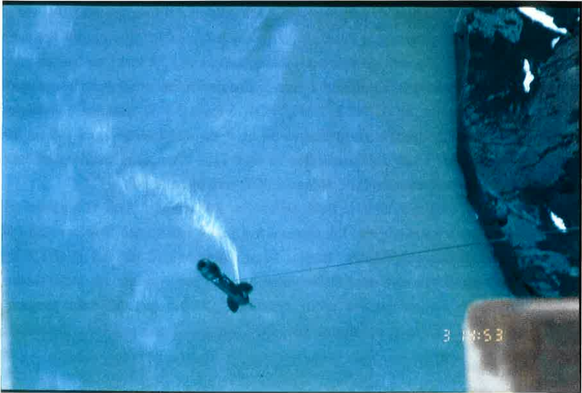
2. mynd. Gruggsýnatakinn dreginn upp til brúar. Gatið sem hellt er úr í sýnafötur er opið svo vatn rennur úr takanum.
