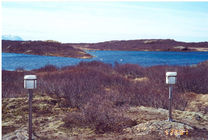
Mynd 1. Úrkomusafnarar á Litla-Skarði (Myndir: Umhverfisstofnun)
