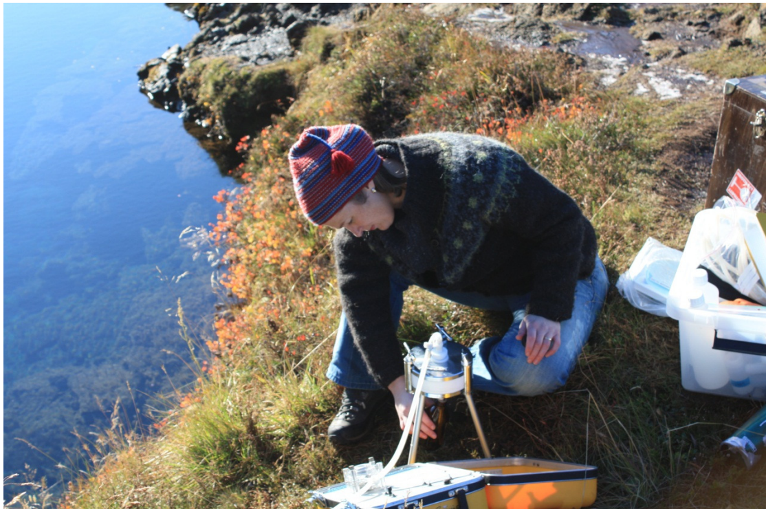
Mynd 3. Við söfnun úr Silfru. Sýni er dælt beint úr lindinni í gegn um síu í söfnunarflöskurnar.
