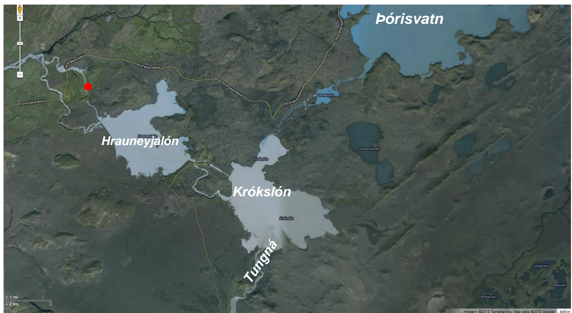
Mynd 4. Loftmynd af miðlunarsvæði Sporðöldulóns. Vatn úr Tungná og Þórisvatni safnast í Krókslón, sem rennur í Hrauneyjalón, í gegn um Hrauneyjafossvirkjun og í Sporðöldulón. Sýnum var safnað af Hrauneyjafossvirkjun, beint ofan útfalls virkjunarinnar (rauður punktur). Loftmynd fengin af http://maps.google.com/ .
