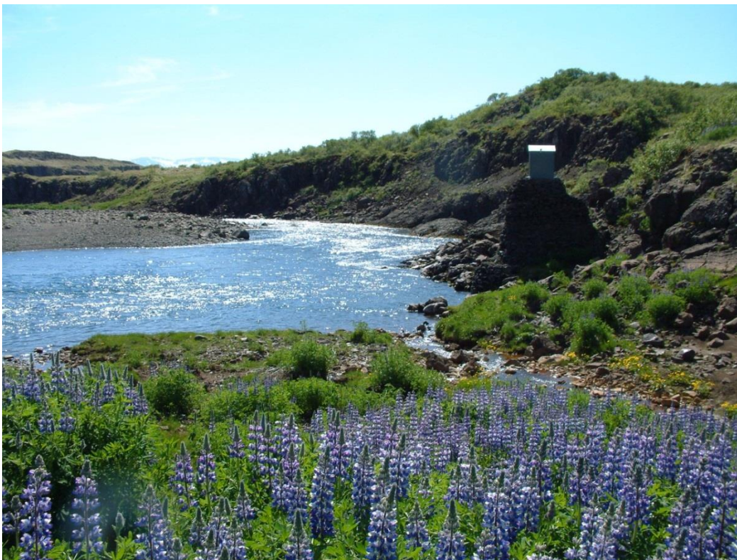
Mynd 2. Vatnshæðarmælirinn í Norðurá við Stekk stendur á hátt yfir ánni, en ekki veitir af þar sem vatnshæðin hækkar mjög á mælistaðnum í flóðum vegna þrænginga í árfarveginum.
