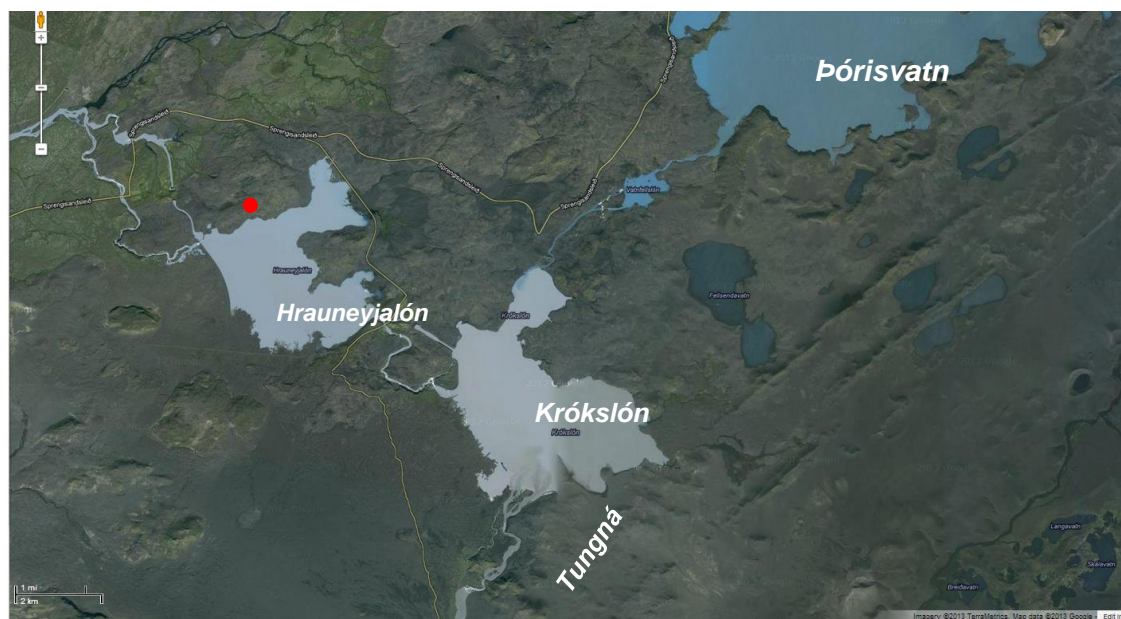
Mynd 3. Loftmynd af miðlunarsvæði Sporðöldulóns. Vatn úr Tungná og Þórisvatni safnast í Krókslón, sem rennur í Hrauneyjalón, í gegn um Hrauneyjafossvirkjun og í Sporðöldulón. Sýnum var safnað af Hrauneyjafossvirkjun, beint ofan útfalls virkjunarinnar (rauður punktur). Loftmynd fengin af http://maps.google.com/ .
